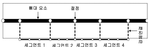
그림 3. 비부착 CFRP 판의 이상화
