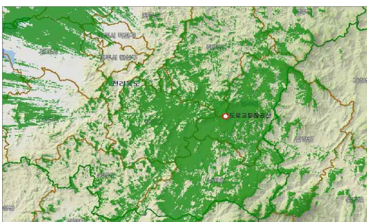
그림 23. 장수 FM 중계소 방송 구역도(팔공산) Fig. 23. Broadcasting area of Jangsu FM relay station (Mountain Palgong).
