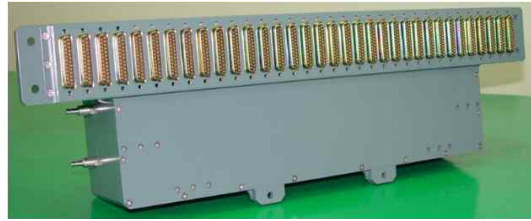
그림 17. 제작된 전원 공급기 Fig. 17. Photo of power supply.
