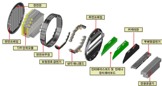
그림 3. AESA 안테나 배열 조립도 Fig. 3. Exploded view of AESA antenna array.
