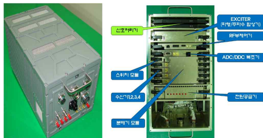
그림 18. RF/처리 장치 형상 Fig. 18. Photo of RF and processor.
