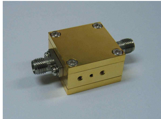
그림 5. Solderless 방식의 수직 연결 시험 시료 Fig. 5. Solderless type vertical interconnection test fixture.
