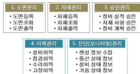
<그림 2> u-MES 시스템 모듈 구조 및 기능
