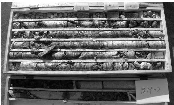
그림 5. 초미립자주입재 시험공에 대한 시추조사 결과
