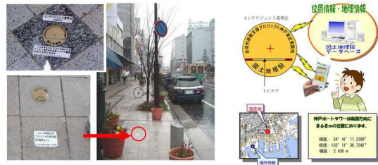
<그림 2> 일본 고베시에 설치된 인텔리전트 기준점
