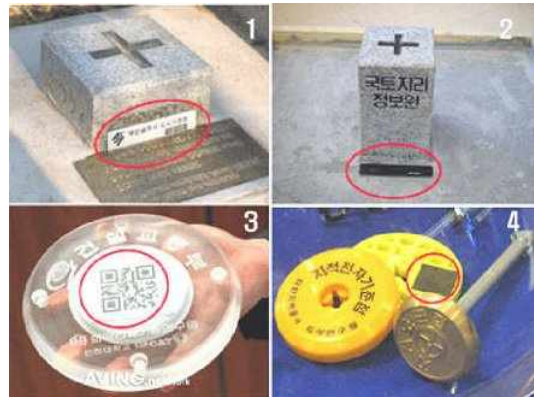
<그림 1> RFID를 적용한 기준점 사례 (1:부산광역시, 2·3:건설교통부, 4:지적연구원)
