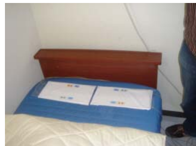
그림 2. 베개에 장착된 생체신호 측정 시스템 (일본 카나자와대학 야마코시 연구실)
