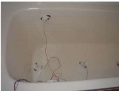
그림 3. 심전도 측정이 가능한 욕조 (일본 카나자와대학 야마코시 연구실)
