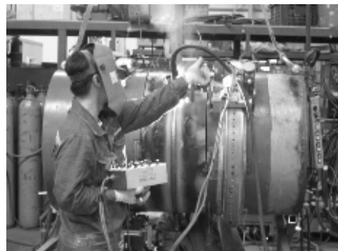
그림 1 FCAW 용접시험편 제작
