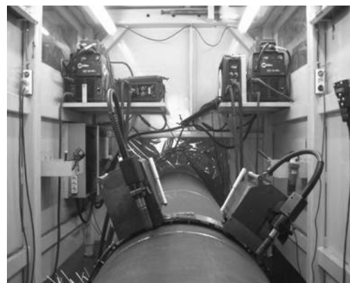
그림 3 GMAW 용접시험편 제작과정 및 용접 그루부 형상
