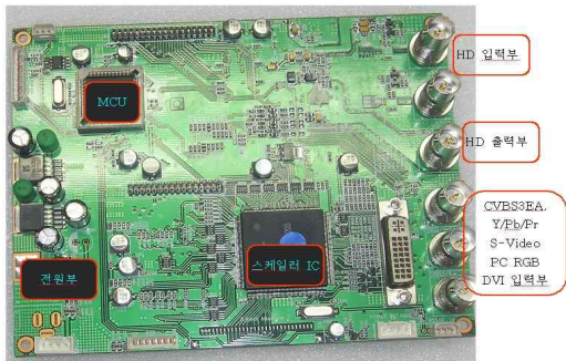
그림 7. MAIN 기판의 윗면(부품면) 사진 Fig. 7. Up-side Image of the main Board
