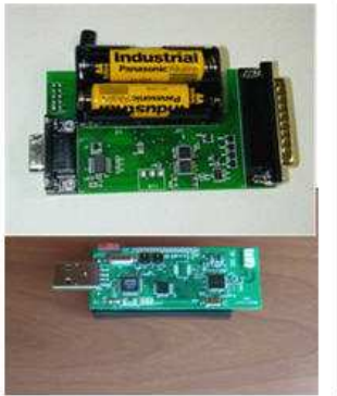
Fig. 2. Sensors for temperature, humidity, light 그림 2. 온도, 습도, 조도 측정용 센서
