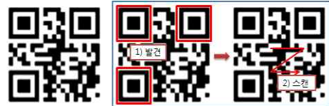
(그림 4) QR코드와 디코딩 과정
