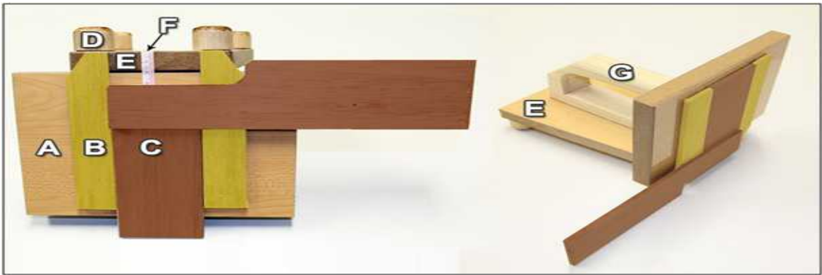
그림 1. Scapulometer의 구성; A: 안정판(stationary board), B: 가이드판(guide board), C: 이동판(sliding board), D: 발(foot), E: 몸체(body), F: 줄자(ruler), G: 손잡이(grip handle).
