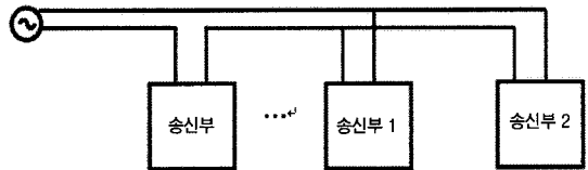
[그림 2] 폐루우프 PLC(CPLC)의 기기연결
