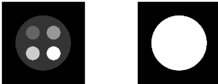
그림 2. 모의 팬텀의 크기 영상. 좌: 비균일 팬텀, 우: 균일 팬텀 Fig. 2. Magnitude maps of the test phantoms. Left: Non-uniform phantom, right: uniform phantom
