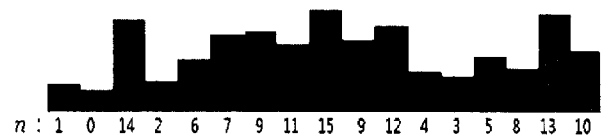
그림 2. 2D CRD의 단면 Fig. 2. Side view of 2D CRD.
