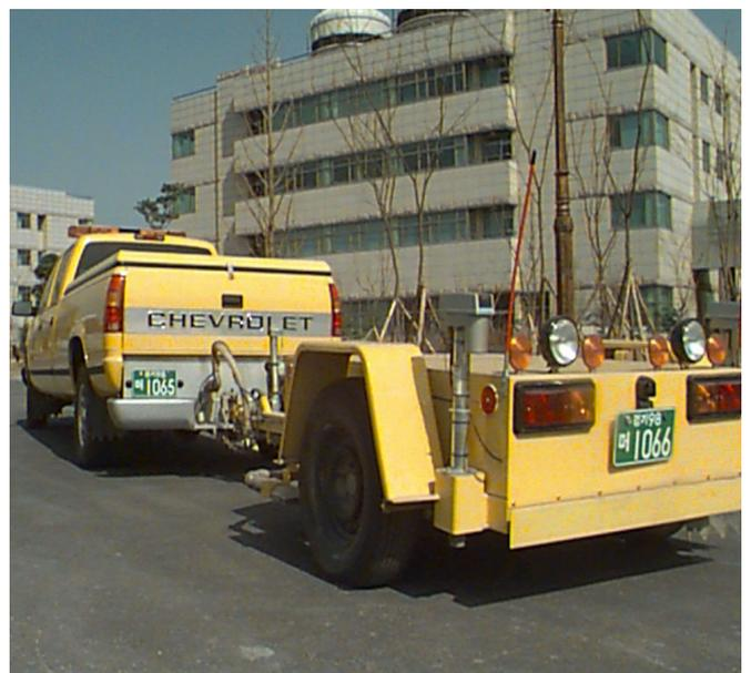
그림 2. 노면 미끄럼 저항 측정 장비
