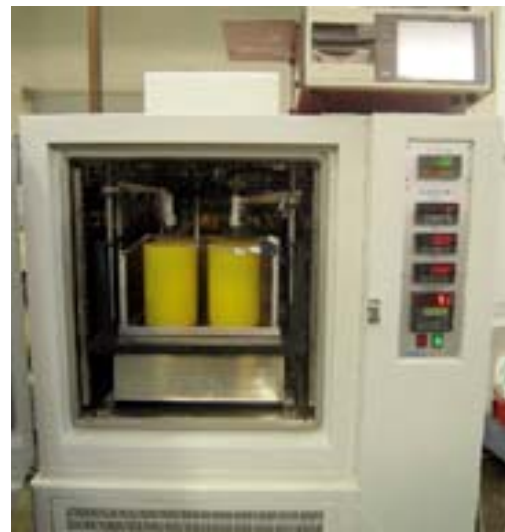
그림 4. 실내동결시스템 시험 장치
