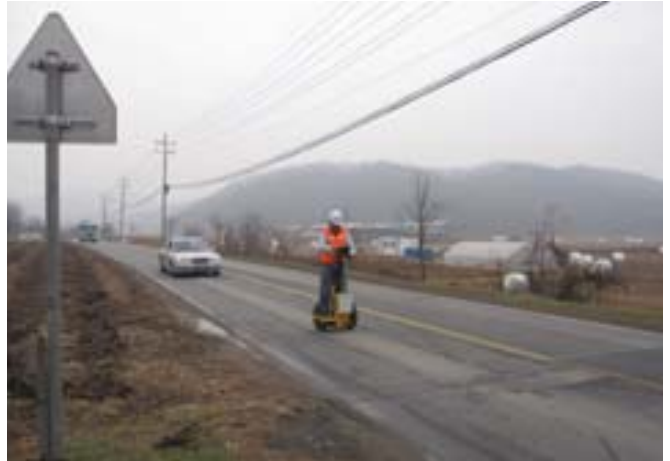
그림 2. 최소단면 보수지역 평탄성 측정
