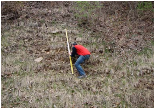
그림 7 스테프와 클리노미터를 이용한 사면의 경사/경사방향 측정
