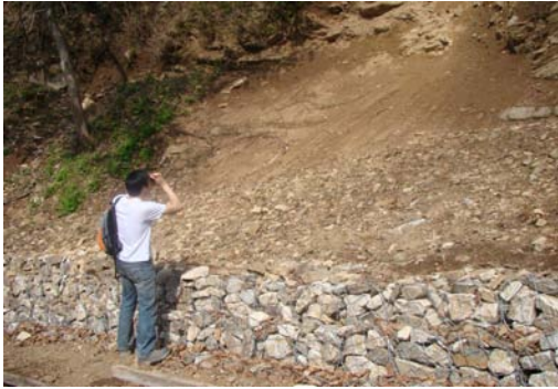
그림 6 Scout를 이용한 사면의 폭과 길이 측정
