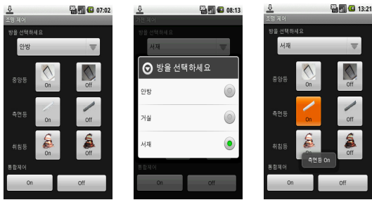
그림 11. 조명 제어 Fig 11. Lighting control
