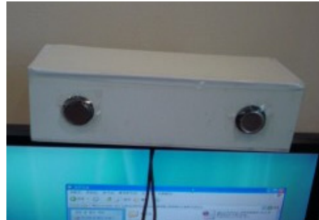
그림 8. 제작된 낚시대 검출용 카메라 Fig 8. The implemented camera for fish pole detection
