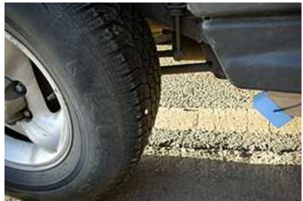
그림 4. 초음파 신호 획득을 위한 센서부착 Fig. 4. Sensor adhesion for ultrasonic wave acquisition
