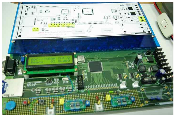
그림 5. 실험용 데이터 로거 장치 Fig. 5. Data Logger unit for experiment
