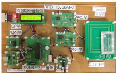
그림 3. 구현된 RFID 시스템
