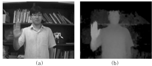
(그림 1) TOF 카메라의 입력 영상과 깊이 영상 (a) 카메라 입력 영상 (b) TOF 깊이 영상
