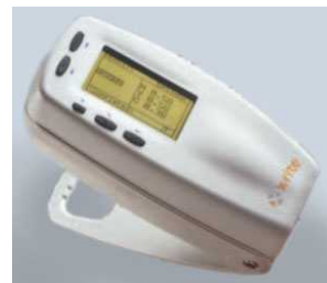
그림 1. 표준 색차계 시스템 Fig. 1. Standard Spectrophotometer System
