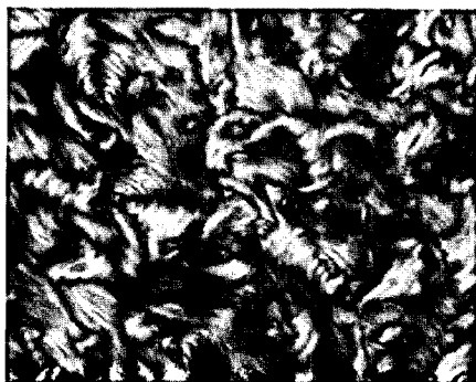
그림 16. Super acid 안에서 액정성을 지니는 CNT의 모습.
