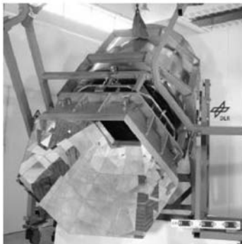
Fig. 5. SOLGATE 프로젝트 가압공기식 흡수기 (가스터빈+증기터빈 활용).
