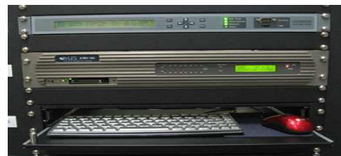
그림 1 게이트웨이(AMC-1G)의 시제품 Fig. 1 The prototype of gateway(AMC-1G)
