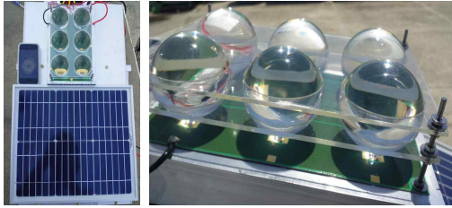
그림 6 실험을 위한 실리콘 태양전지와 CPV 모듈 사진 Fig. 6 Photograph of the experiment setup with Si and CPV module
