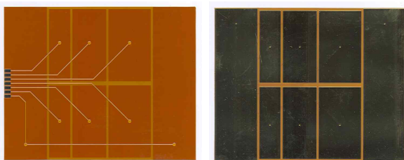
그림 17 제작된 Flexible PCB 센서의 단면도 Fig. 17 Flexible PCB layout for capacitive-conductive sensor
