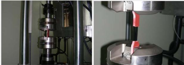
그림 6 반복피로 스트레스에 대한 시험 사진
