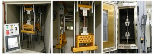
그림 4 인장스트레스에 대한 SIM 시험 사진
