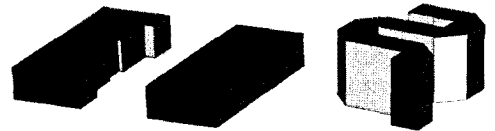
(b) 위상 기울기 및 크기 보정용 도파관 (b) Waveguides for dispersion compensation
