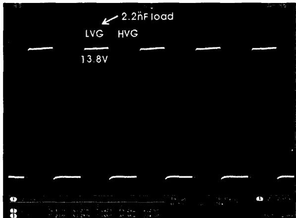
그림 14. HVG, LVG의 출력파형 Fig. 14. Output waveform of HVG, LVG.
