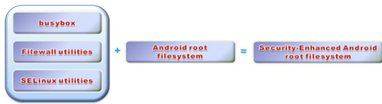
[그림 5] 보안 Application용 Root FS reorganization
