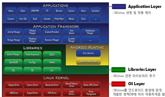
[그림 2] 전체 시스템 구성도
