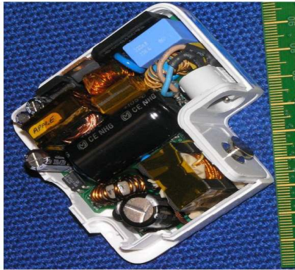
그림 1 Buck 컨버터와 Half-bridge의 이단구조를 갖는 고 전력밀도 어댑터 Fig. 1 High power density adaptor with Two-stage structure comprised of buck converter and half-bridge converter
