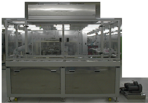
[그림 12] 클린 컨베이어의 개발 시작품
