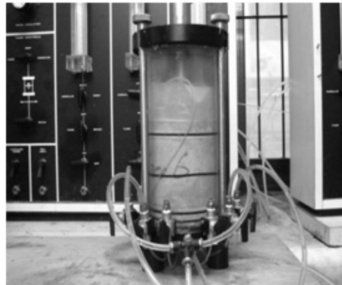
시멘트 그라우트 투수계수 측정
