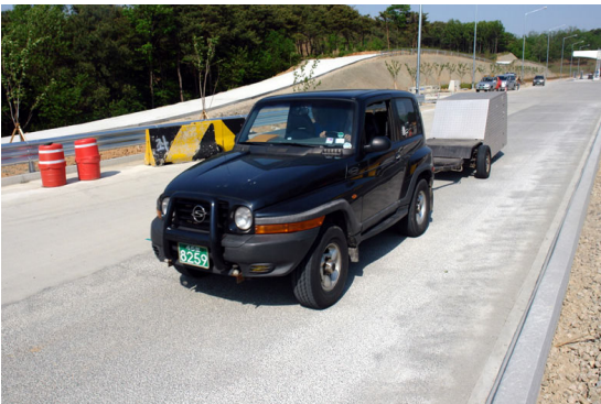
그림 6. CPX Trailer를 이용한 근접소음 측정
