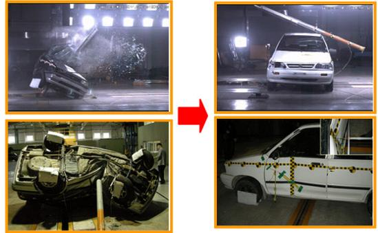
그림 2. 충돌피해 최소화를 위한 지주 및 단부고정장치 개발
