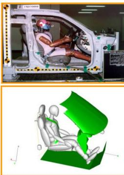
그림 9. 고령자 인체상해기준 및 상해해석모델 개발을 통한 충돌안전장치 기술개발
