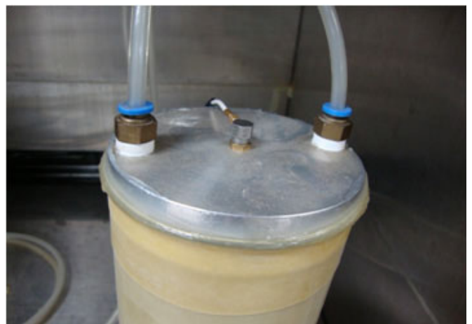
사진 2. 진공응력재하 관 및 가속도계가 설치된 단부캡
