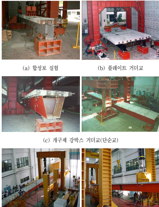
(a) 합성보 실험 (b) 플레이트 거더교 (c) 개구제 강박스 거더교(단순교) (d) 개구제 강박스 거더교(연속교) 사진 2. 모형 교량실험
