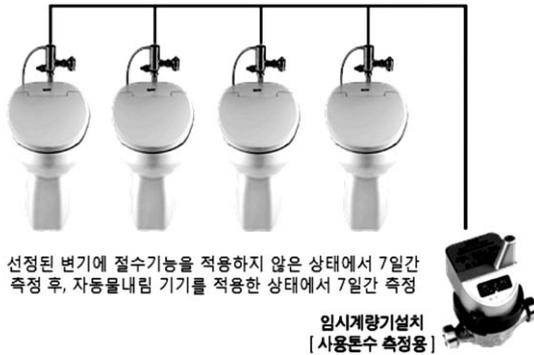
선정된 변기에 절수기능을 적용하지 않은 상태에서 7일간 측정 후, 자동물내림 기기를 적용한 상태에서 7일간 측정
