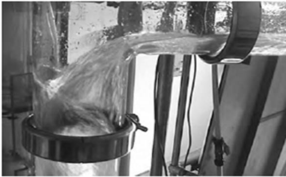
[그림 1] 가지관으로부터 입상관으로 유입되는 배수 (Heriot-Watt 대학교)
