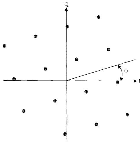
(그림 1) 회전 성상도(16QAM 변조 방식의 예)
