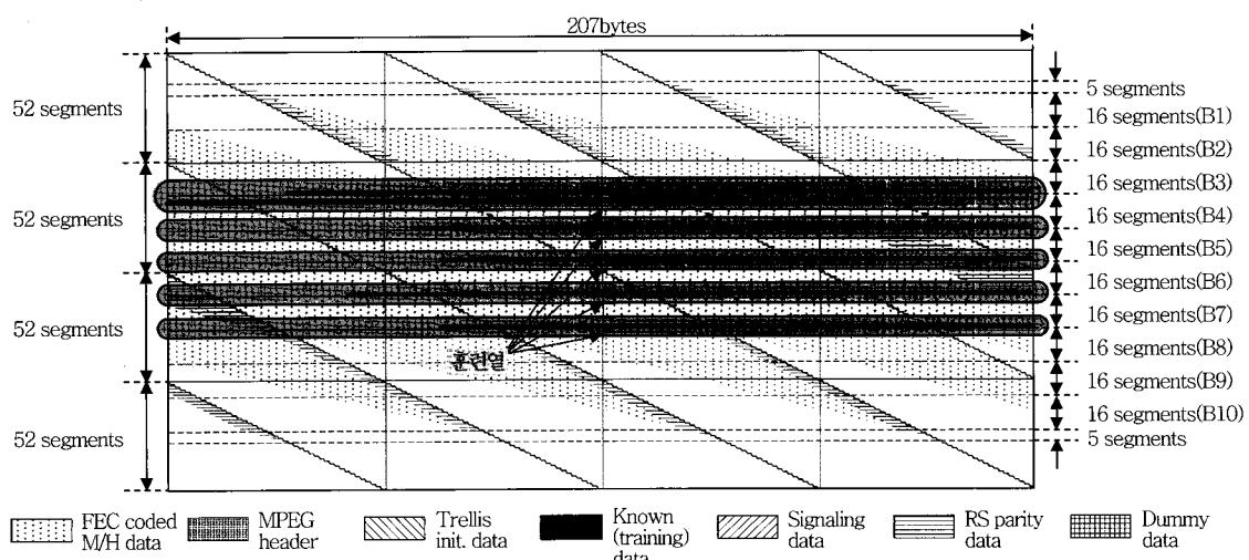
(그림 6) ATSC 모바일 DTV 전송 프레임 구조[6]
