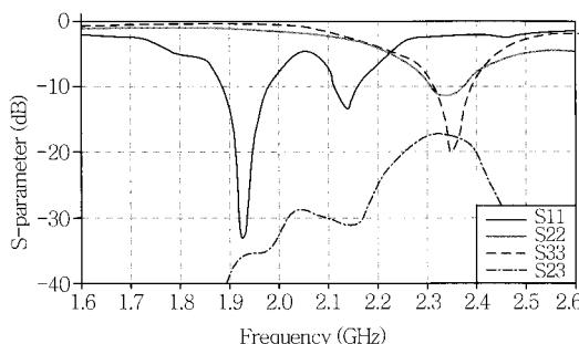
(그림 10) Multi-antenna의 S-parameter 측정 결과
