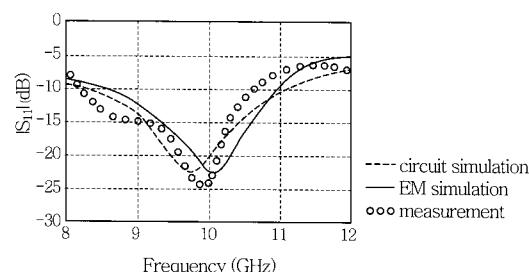
(그림 8) Wideband DNG ZOR 안테나 S-parameter
