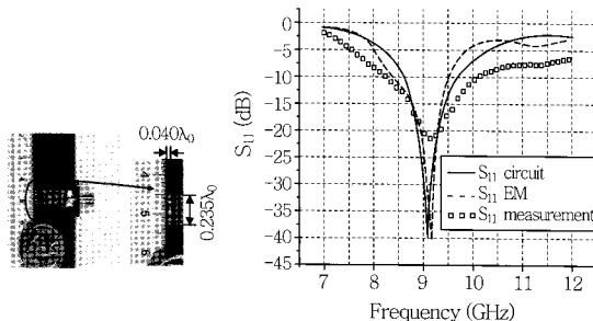
(그림 6) Wideband ENG ZOR 안테나 제작 및 S-parameter 측정 결과
