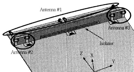
(그림 9) ENG-ZOR 단위 셀을 이용한 Multi-antenna
