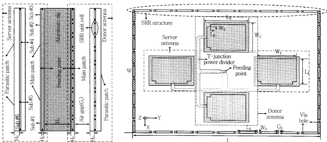
(그림 14) SRR 구조를 이용한 댁내형 중계기 안테나
