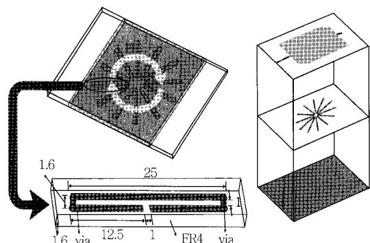
(그림 11) AMC를 이용한 RFID 리터 안테나 구조
