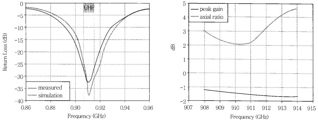
(그림 12) 제작된 RFID 리더 안테나 반사손실 비교 및 축비, 이득 특성
