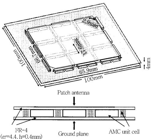
(그림 13) 제작된 AMC RFID 단말기 리더 패치안테나
