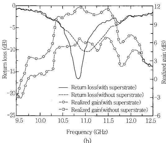
(그림 19) 단위 셀의 유효매질 추출 결과(a)와 안테나 이득 및 반사 손실(b)
