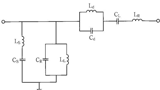
(그림 31) Quad-band CRLH-TL의 회로 구조
