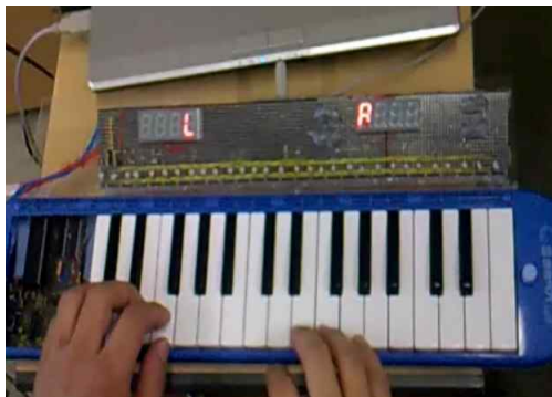
그림 14. USB Interface 전자악기 연주 Fig. 14. The Electronic Keyboard Instrument play using the USB interface
