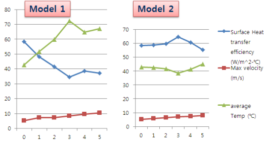
그림 9: 압전소자용 방열판의 모델 1 및 2에 대한 열 성능 데이터.
