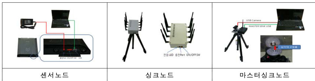
그림 2. USN-기반 이동식 기준장비의 시스템 구성
