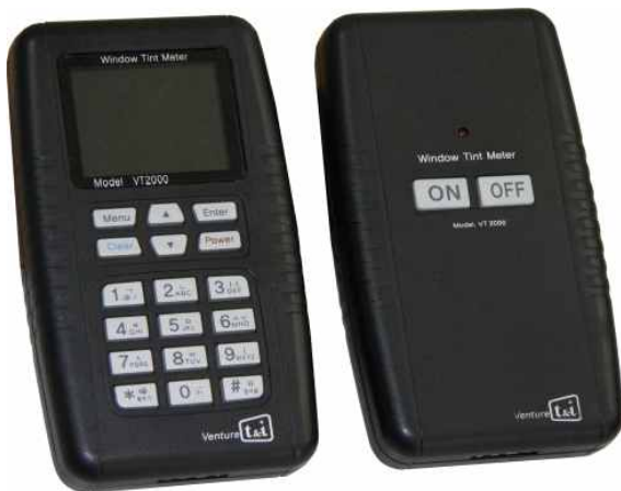
그림 11. 개발된 휴대용 투과율 측정기 (좌) 수광부, (우) 발광부 Fig. 11. Developed transmittance measurement system (left) light receiving part, (right) light emitting part
